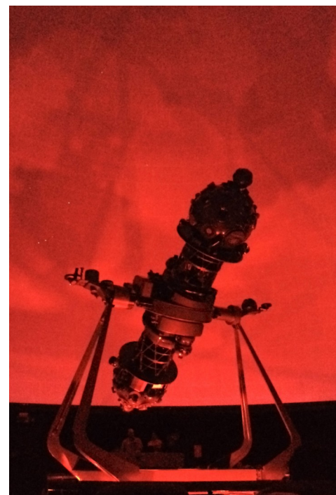
Sistema óptico-mecánico del Planetario Chile, que permite simular el cielo visto desde cualquier parte de nuestro planeta. Imagen de autoría propia.
